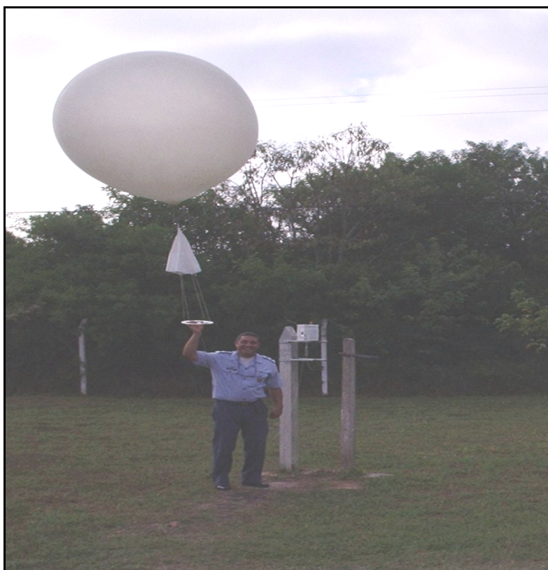
Figura 3.2- Procedimento de lançamento do balão de radiossondagem no Aeroporto Internacional Salgado Filho em Porto Alegre.
